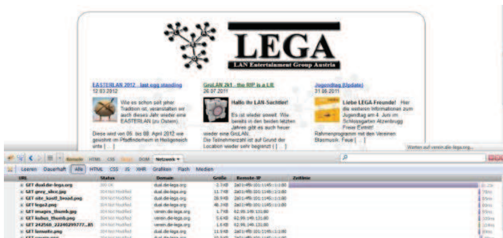
Abb. 33: Adressauflösung des Browser für dual.die-lega.org mit globaler IPv6 Adresse
